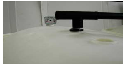
Slika 6b: Vrinjenje odzračevalnega voda
