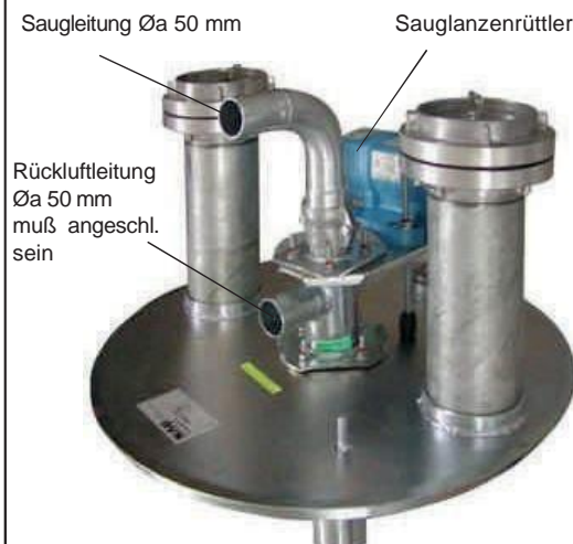
Bild 3: Schlauchmontage
