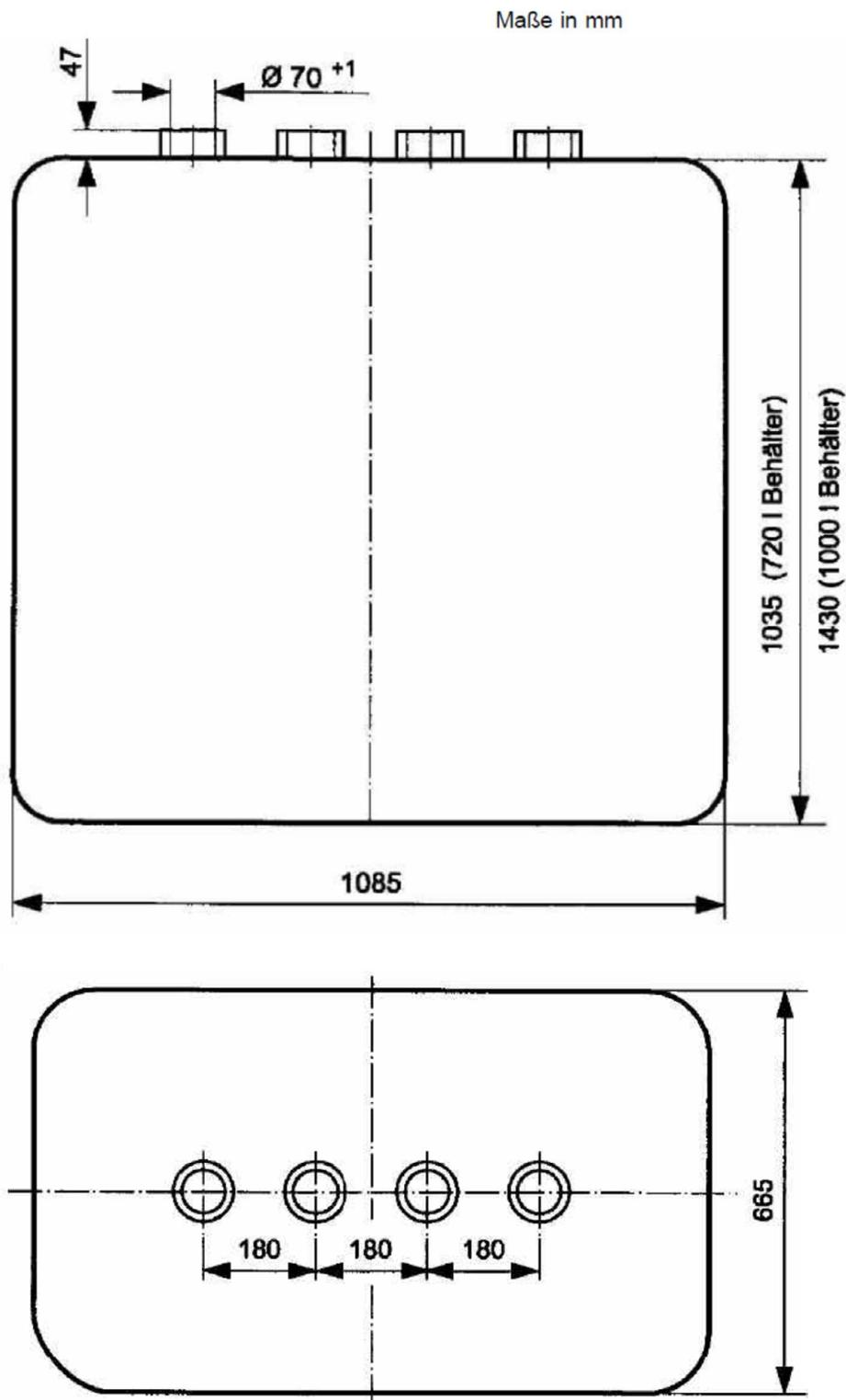
Blasgeformte Behälter aus Polyethylen (PE-HD)
