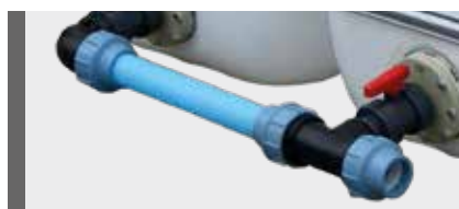
Untere Verbindungsleitung mit Anschlussflansch und Absperrhahn 1 ½" für PE-Lagerbehälter für bauseitigen Anschluss Kunststoff-Rohr DN 50 (Außendurchmesser 63 mm).
